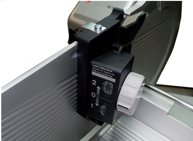
Abb. 5: Aufschnittschneidemaschine mit angebrachtem separatem Messerschleifapparat
