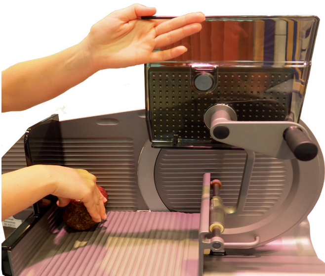
Abb. 7: Das Schneidgut wird bei angehobenem Schneidguthalter und zurückgezogenem Schlitten an die Schlittenrückwand gedrückt
