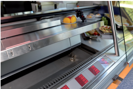
Abb. 18: Kippbarer Thekenboden auf der Kundenseite
