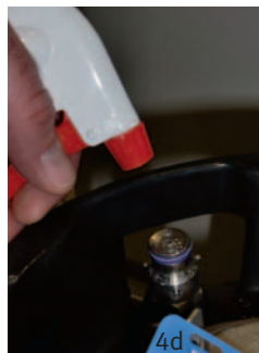
Abb. 4a: Reinigen der Steckverbindung in sauberem, warmem Trinkwasser Abb. 4b-4c: Desinfizieren des Zapfkopfes (4b), der Steckverbindungen (4c) der Behälteranschlussteile (4d), Abbildung eines Bag-in-Box-Anschlusses (4e)
