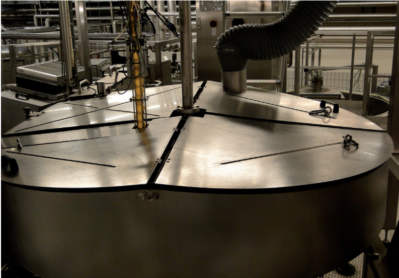
Abb. 6: Geschlossenes Kappenbad mit zusätzlicher Absaugung
