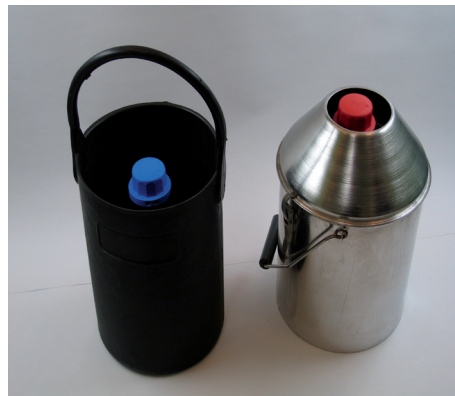
Abb. 6: Sicherheitsbehälter für den Handtransport
