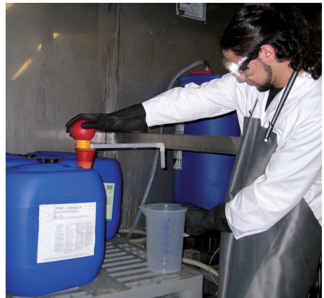
Abb. 3: Handpumpe zur Entnahme aus Kanistern
