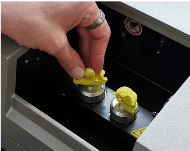
Abb. 29 Positionierung der Abformungen im Laserscanner
