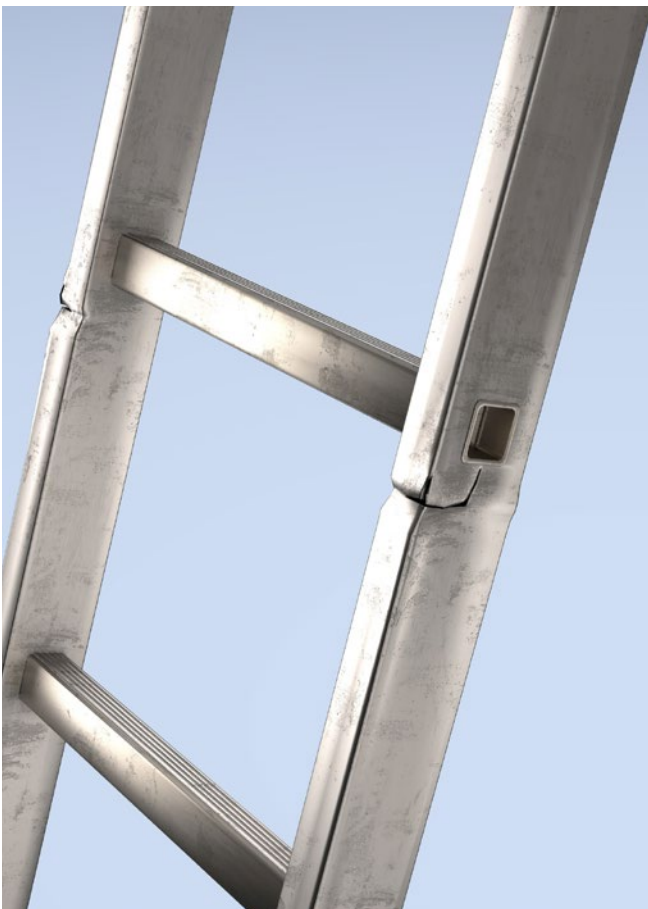
Abb. 69 Beispiel einer stark beschädigten Leiter, die nicht mehr verwendet werden darf
