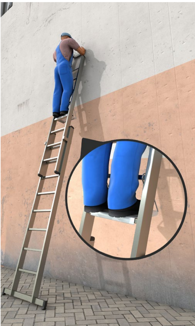
Abb. 17 Schiebeleiter mit Einhängepodest
