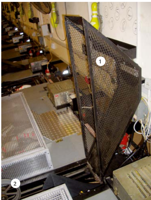
Abb. 30 Sicherung der Gefahrstellen im oberen Bereich des Ballrücklaufes (Ballbeschleuniger)
