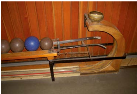
Abb. 13 Endlauf ohne Verkleidung – erlaubt nur für seilgeführte Stellmaschinen, welche bis zum 30.09.1990 in Betrieb genommen wurden
