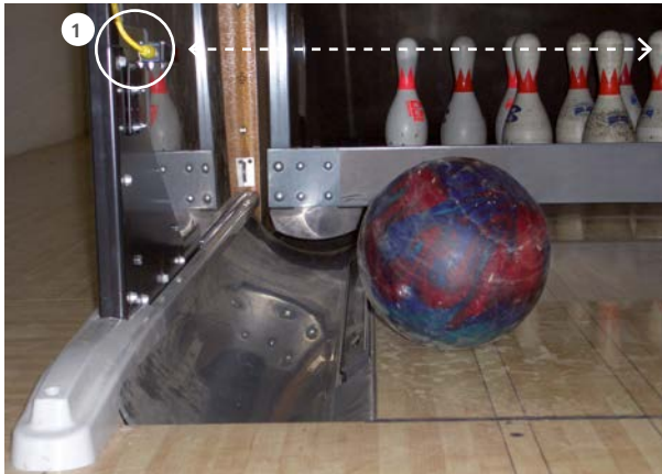
① Sicherheitslichtschranke mit Lichtstrahl
