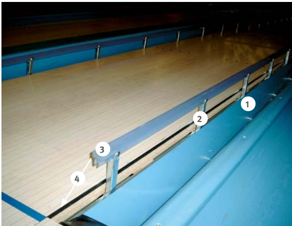
Abb. 42 Gefahrstellen am kraftbetriebenen Bumper beim Absenken
