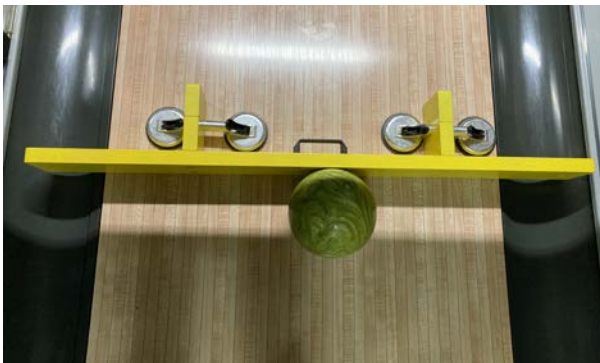
Abb. 50 Personenschutz durch arretierten Prallschutz
