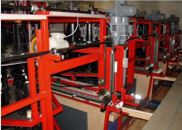
Abb. 16 Ungesicherte Kettentriebe des Abräumers
