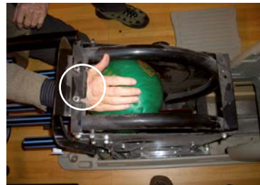
Abb. 36 Quetschstelle zwischen Ball und Querstrebe
