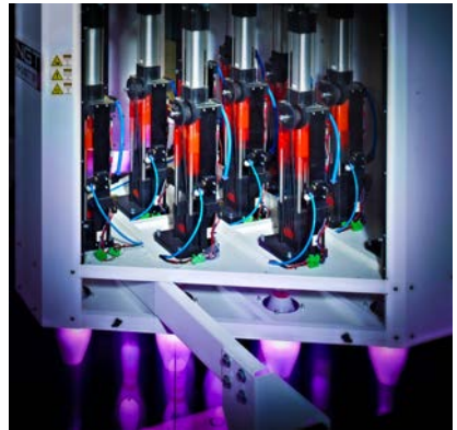
Abb. 7 Sicherung der Gefahrstellen des Pinsetters durch Begrenzung der wirksamen Energie mittels Druckluftsteuerung und zusätzlicher Verkleidung bzw. Einhausung
