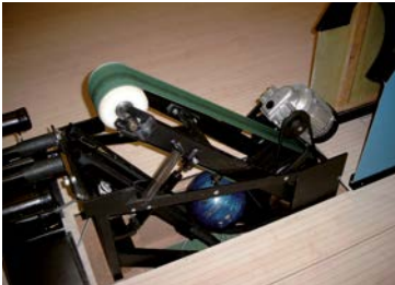
Abb. 33 Einzugsstelle zwischen Flachriemen und Umlenkrolle
