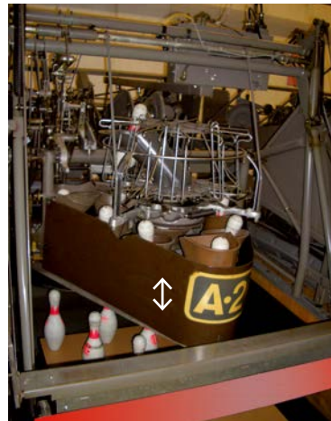
Abb. 26 Mögliche Gefahrstellen zwischen bewegten Bauteilen und fest stehenden Bauteilen bzw. der Bahn im vorderen Bereich der Stellmaschine
