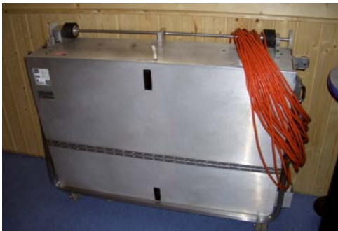
Abb. 45 Nicht gesicherte, hochkant stehende Maschine zur Bahnpflege
