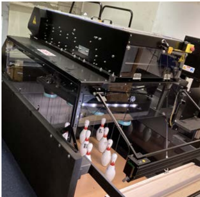
Abb. 6 Gesicherte Gefahrstellen der Stellmaschine bzw. des Schlittens mittels verschraubten und elektrisch verriegelten Verdeckungen
