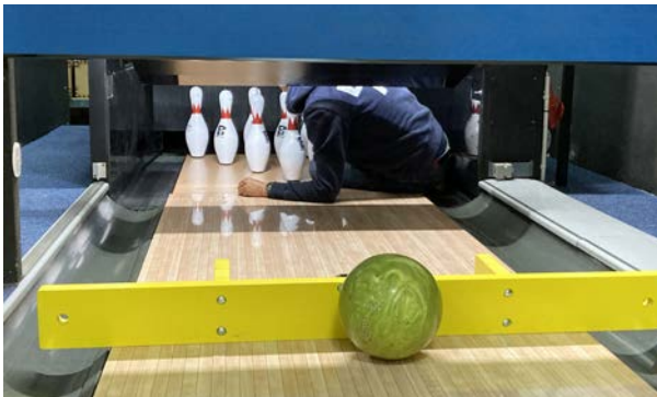
Abb. 49 Personenschutz durch arretierten Prallschutz
