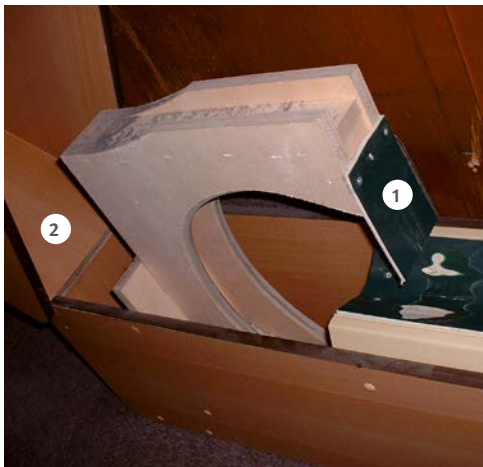
Abb. 11 Kugel- bzw. Ballendlauf mit Einrichtung zum Bremsen (obere Verdeckung des Endlaufs aufgeklappt)
