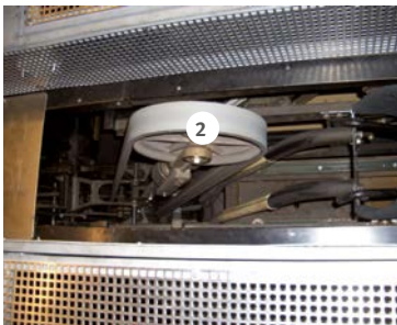
Abb. 29 Gefahrstellen im Bereich des Ballrücklaufes (Ballbeschleuniger)
