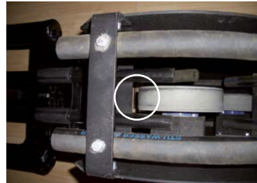
Abb. 34 Einzugsstelle zwischen kraftbetriebener Rolle und fest stehenden Bauteilen (Ansicht von oben)
