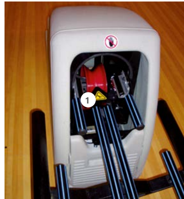
Abb. 38 Schutzmaßnahme: Bewegliche Klappe (mit dem Antrieb elektrisch verriegelt)
