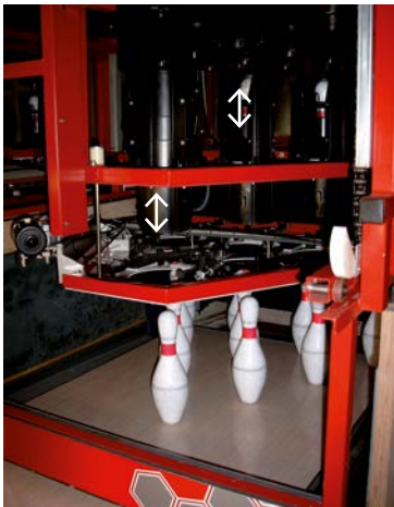
Abb. 26 Mögliche Gefahrstellen zwischen bewegten Bauteilen und fest stehenden Bauteilen bzw. der Bahn im vorderen Bereich der Stellmaschine
